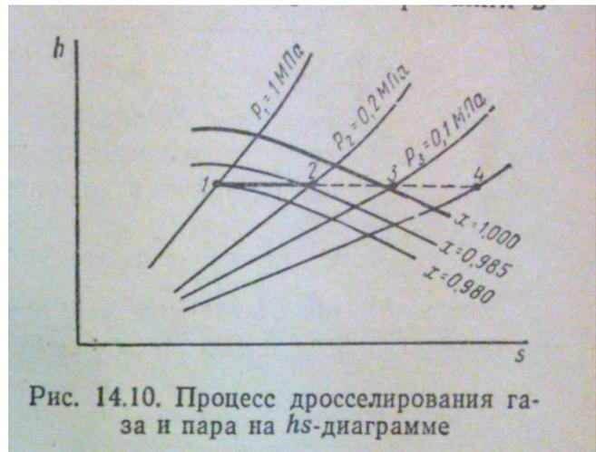
Рис. 14.10. Процесс дросселирования газа и пара на  $hs$ -диаграмме
