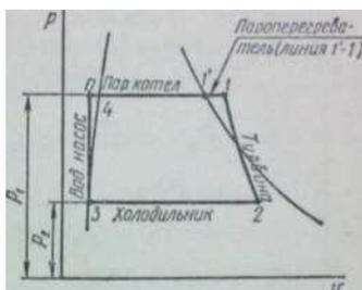
В цикле Ренкина предусматривается полная конденсация пара в конденсаторе. На  $p-v$ -диаграмме, показанной на рис. 15.5, видно, что этот цикл состоит из изобары 0-7 подвода теплоты в теплоотдатчике, адиабаты 7-2 расширения пара в паровом двигателе, изобары 2-3 отвода теплоты в теплоприемнике и изохоры 3-0 повышения давления в питательном насосе (см. рис.
